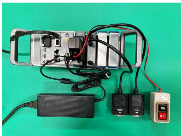
図1. データロガーを使用した電費算出用検査装置
