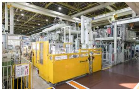
明知工場 試作用ダイカストマシン ©TMC
