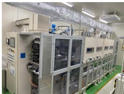
ドライ環境に設置した塗工装置
