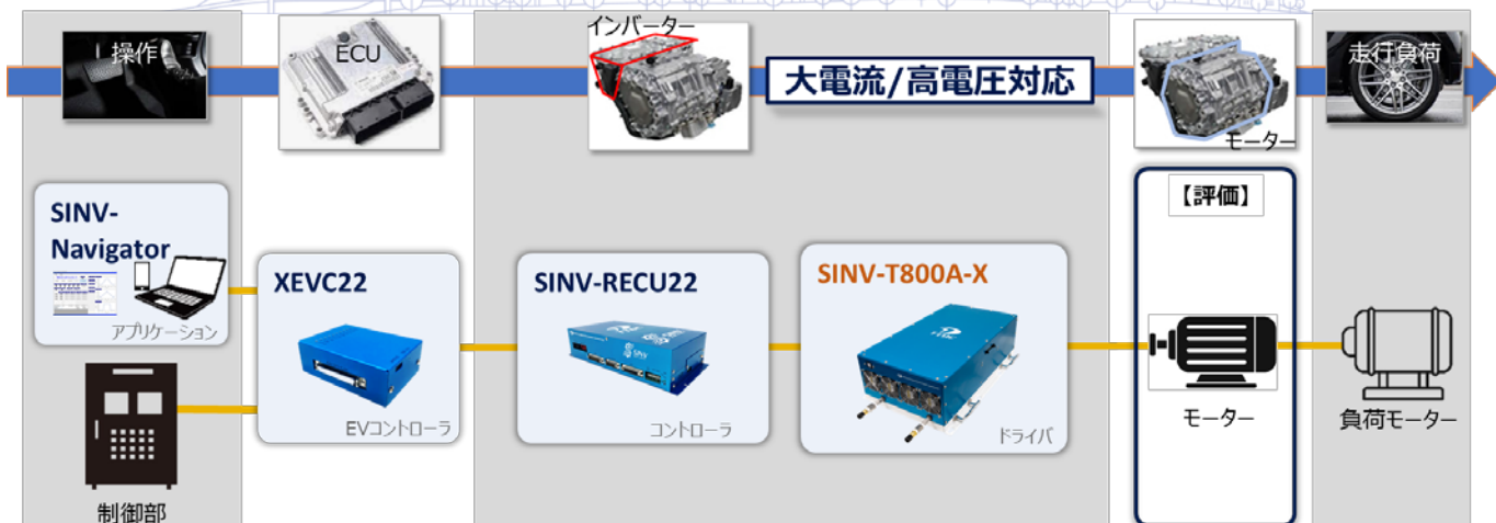
高圧BEV評価時の接続例
